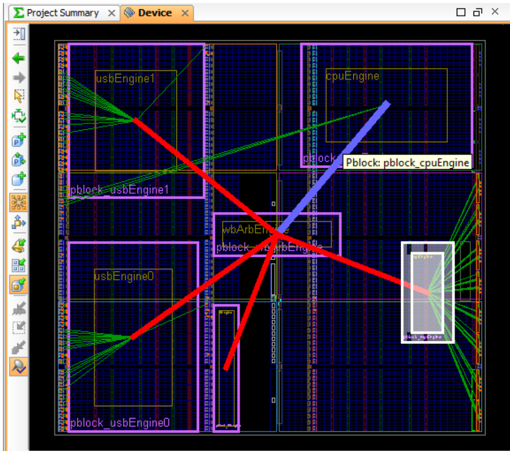
図 44 : Pblock の形を変更して階層接続を表示
