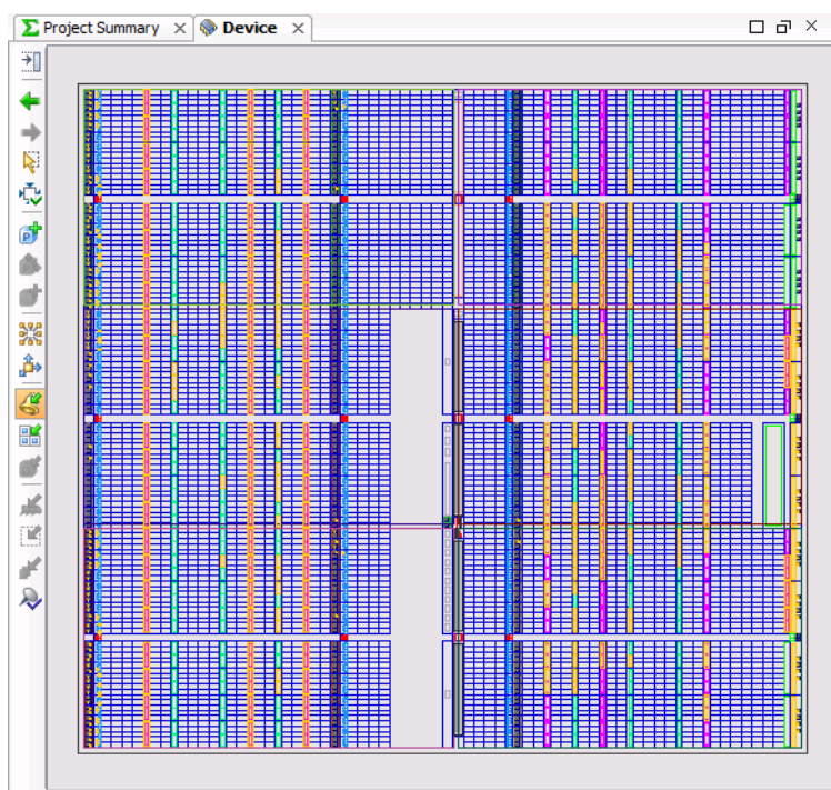
図 1-2 : 手動でフロアプランされたロジック
